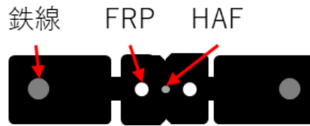
図 13－隙間配線インドア光ファイバ構造イメージ
