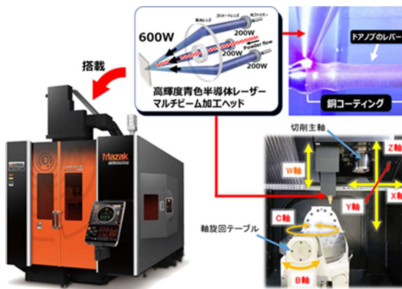
図1 高輝度青色半導体レーザーマルチビームヘッドを搭載したハイブリッド複合加工機
