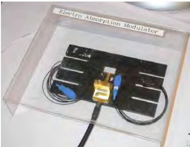
写真 3 歪補償 EA 変調器
